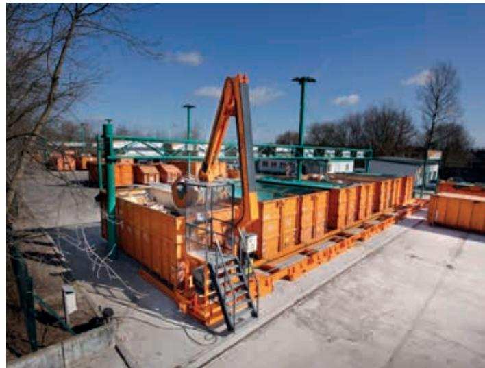
**Il Rullo Compattatore RP7700VS è la soluzione ideale per compattare rifiuti voluminosi in container a cielo aperto fino a 7 metri, riducendo al minimo il numero di viaggi di smaltimento ed i relativi costi.**
